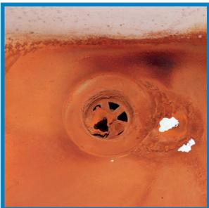
Typische Merkmale für oxidiertes Eisen und Mangan im Wasser sind braune bzw. schwarze Wasserfärbung, unangenehm metallischer Geschmack und Rückstände bei Sanitäranlagen. Neben dieser Fleckenbildung führt hoher Eisen- und Mangangehalt auch zu allmählicher Verstopfung von Rohren, Ventilen und Düsen und damit für Sie zu erhöhten Wartungs- und Reparaturkosten.
